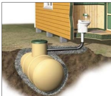
Figur 10. Figur til venstre viser skisse av nedgravd tett tank for klosettavløp. Figur til høyre vier er gråvannsrenseanlegg med biofilter. Figurene er hentet fra avlop.no
