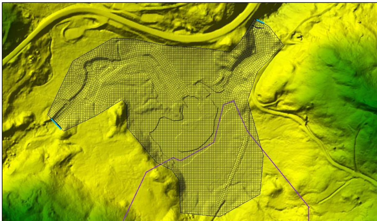
Figur 22: Illustrasjon av terrengmodell, beregningsgrid og plassering av grensebetingelser for Begna ved Kiladn. Den lille streken er grensa for kartleggingsområdet.
