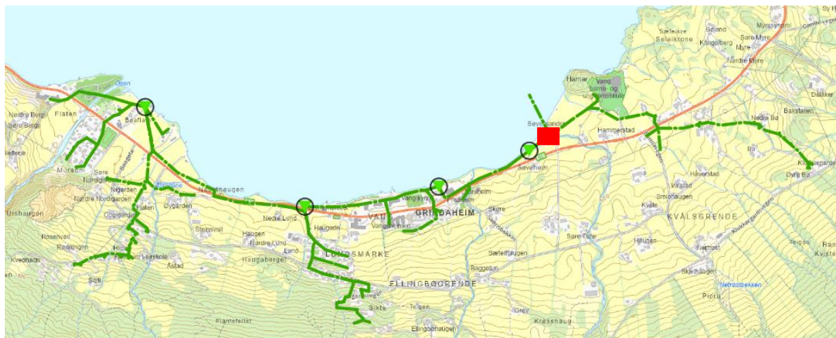
Figur 21. Ledningsnett og pumpestasjoner knyttet til Vang / Grindaheim renseanlegg. Grønne sirkler markerer avløpspumpestasjoner. Rød firkant markerer avløpsrenseanlegget.
