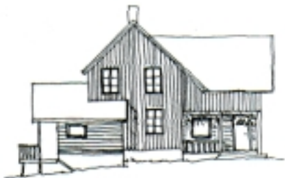
Påbygging i ulike vinklar, høgder og med ulike takvinklar. Bygget si opphavlege form er øydelagt.
