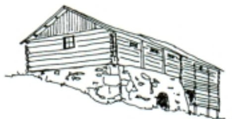
Fjøs og låve tilpassa terrenget med høg gråsteinsmur og trepilarar. (Ein støypt mur ville ikkje hatt same verknad.)
