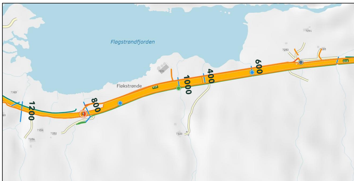
Figur 6: Stikkrenner langs E16 ved Fløgstrønd. Kilde: Vegkart, Statens vegvesen
