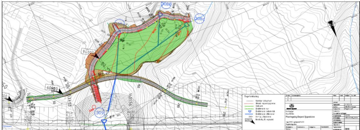
Figur 3 - Skisse over planlagt massedeponi og drenering
